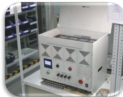
Стенд бескамерных испытаний тепловыделяющих электронных компонентов
